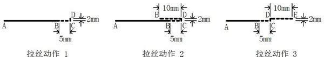
A 点和 C 点是线段点胶的线开始点和线结束点，实线为点胶阀打开时走的路径，虚线
