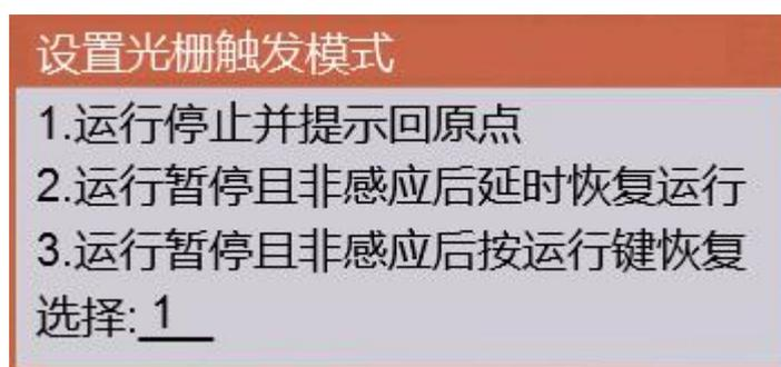
打螺丝过程中，为防止撞坏物体和撞伤人，在运行或者回原点过程中，光栅保护有感应时，会按照设置的光栅触发模式进行响应。
