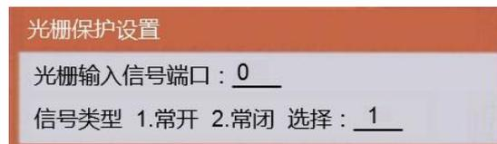
打螺丝过程中，为防止撞坏物体或撞伤人。在运行或者回原点过程中，可以通过光栅信号进行检测，光栅信号的触发模式可以在“菜单 2-第 3 页-6.设置光栅触发模式”中进行设置。当光栅输入信号设为 0 时，表示光栅保护功能无效。
