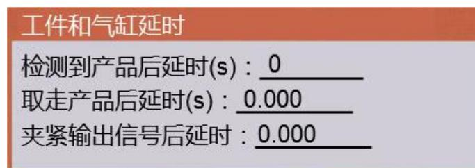
检测到产品后延时(s)：检测到产品后延时一段时间再执行下一步动作。
