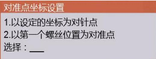
双 Y 轴模式下先要对 Y 轴进行选择，然后再进行对准点坐标设置。
