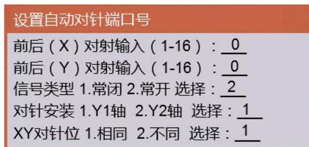
自动对针感应器设置：可以在一个位置同时搜索X、Y 检测。也可以X、Y 分别在不同的位置检测。Z 轴会选择其中一个感应器检测。
