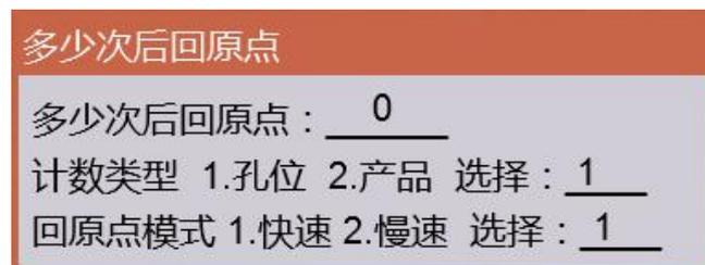
计数类型：1.孔位，如果加工了设定次数的螺丝孔位数，进行一次回原点动作，接着运行；2.产品，如果加工了设定个数的产品数，进行一次回原点动作，如果是在循环运行状态，接着运行。
